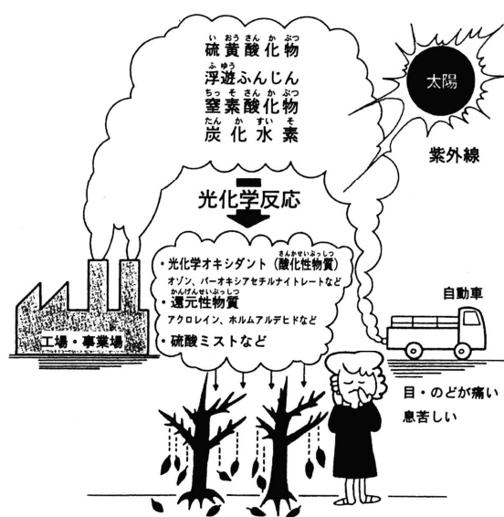
図 光化学スモッグの仕組み
