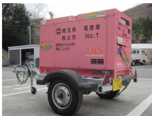
牽引式発電機 （燃料に BDF を使用）
